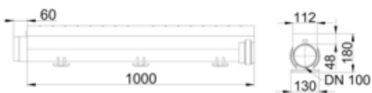
Diamètre nominal 100 mm Volume 12,39 dm 3 Section d'écoulement 75,4 cm 2
