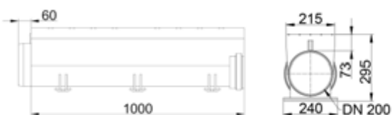
Diamètre nominal 200 mm Volume 42,04 dm 3 Section d'écoulement 265,9 cm 2
