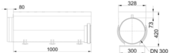
Diamètre nominal 300 mm Volume 92,92 dm 3 Section d'écoulement 702,1 cm 2
